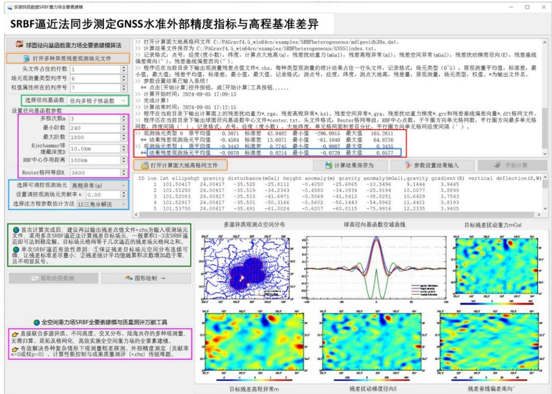
$0.0214^4$  m 是 GNSS 水准实测大地水准面高的外部精度指标，用标准差表示，即 2.14cm。这是 SRBF 逼近法 GNSS 水准实测大地水准面外部精度指标测定方法，其结果表示 GNSS 水准外部精度不低于 2.14cm（标准差）。
