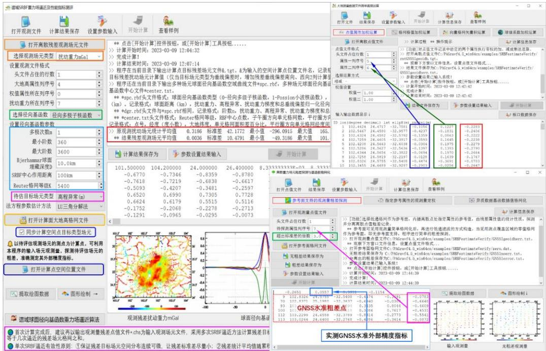
运行程序，选择“同步计算空间目标类型场元”，将 `rntGNSSlgeoidh.txt` 作为计算点空间位置文件输入程序，生成 GNSS 水准实测大地水准面高残差文件 `rntGNSSlgeoidh.tgt`，进而采用 3 倍标准差探测并剔除 GNSS 水准粗差点。本例共 125 个实测 GNSS 水准点，程序探测出 6 个粗差点，实测 GNSS 水准粗差探测与剔除前后的统计结果如表。
