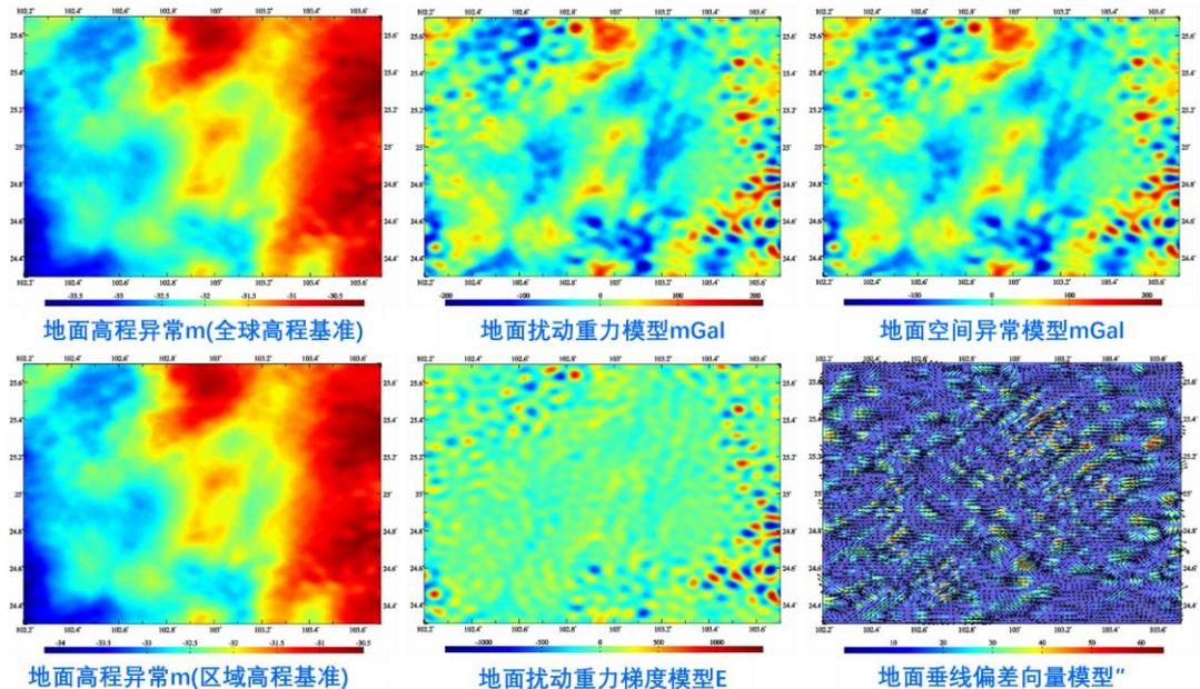
将计算面改为大地水准面，直接生成大地水准面上 30"重力场全要素模型。
