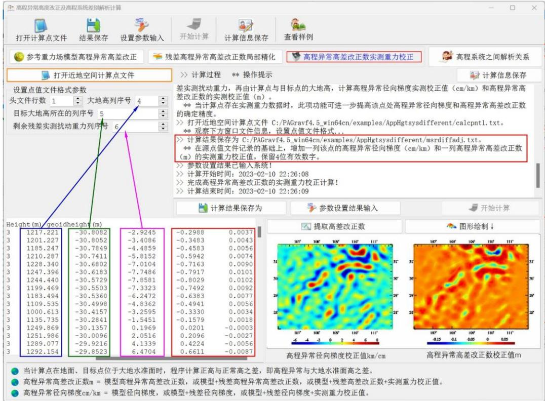
高程异常高差改正数  $m$  = 模型高程异常高差改正数，或模型+残差高程异常高差改正数，或模型+残差高差改正数+实测重力校正值。
