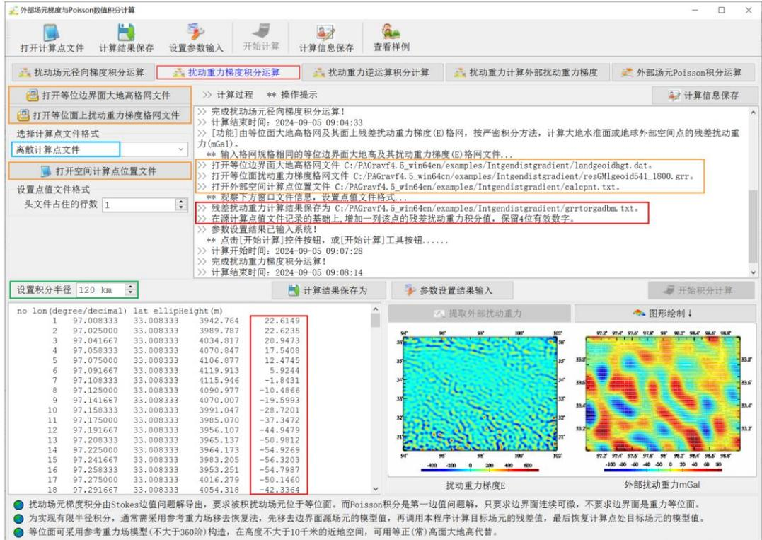
本例采用 120km 积分半径，由大地水准面上的残差扰动重力梯度，计算残差地面扰动重力。扣除外围 2°存在积分边缘效应的格网区域后，统计 541~1800 阶模型残差地面扰动重力（视为参考真值），以及积分计算值与模型参考值之差（用于算法评价）。
