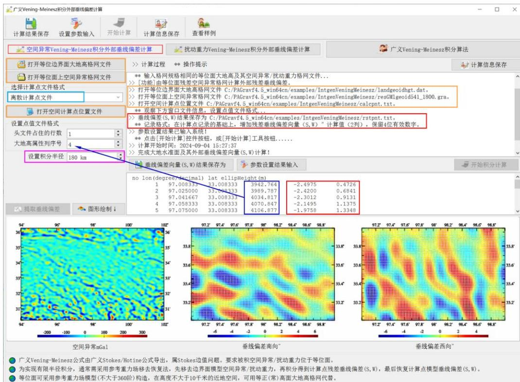
当输入计算面大地高格网文件时，输出同规格格网的残差垂线偏差向量格网文件。
