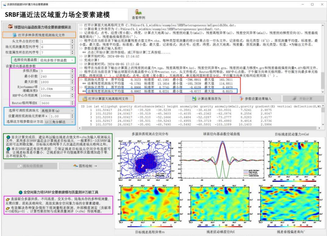
SRBF 重力场逼近程序的技术特色：①观测场元、目标场元及其相互之间具有严密的解析关系，重力场逼近算法性能不受观测场元误差影响；②一步解析融合多种异质、不同高度、交叉分布和陆海共存的重力场观测量，无需归算、延拓及格网化；③同步实现大地水准面及其外部全空间全要素解析建模，能有效融合极少天文垂线偏差或 GNSS 水准数据；④具备强大的重力场观测量粗差探测、外部精度指标及高程基准差异测定与计算性能控制能力。
