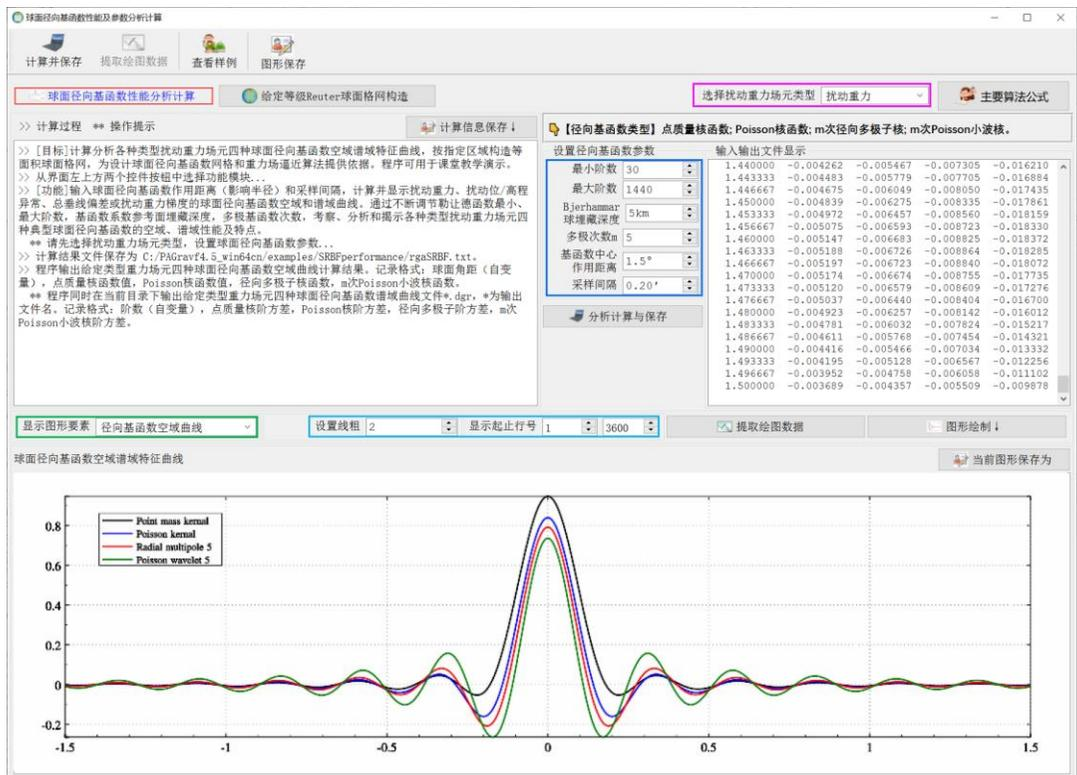
程序在当前目录下同时输出给定类型重力场元四种球面径向基函数谱域曲线文件\*.dgr，\*为输出文件名。
