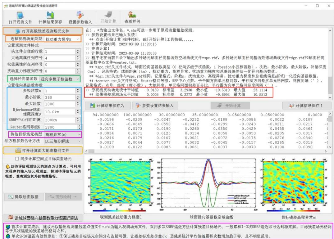
每次 SRBF 逼近采用不同谱域特征的 SRBF, 多次 SRBF 逼近通过组合多个 SRBF 谱域中心及带宽, 就可充分解析目标场元的谱域信号, 避免谱泄漏, 从而在空域中最佳解析地恢复目标场元。
