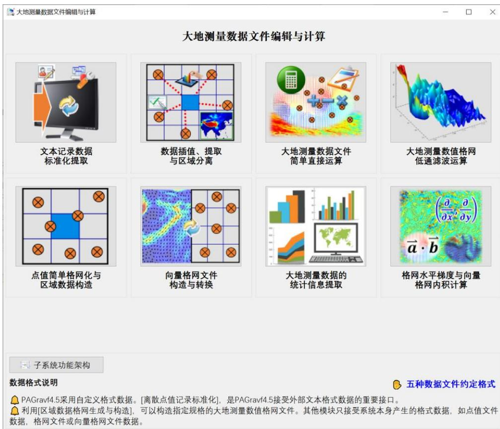
PAGrav4.5 采用自定义格式的 5 种类型大地测量稳态数据文件。[文本记录数据文件标准化提取]，是 PAGrav4.5 接受外部文本格式数据的重要接口。利用[区域数据格网生成与构造]，可以构造指定规格的大地测量数值格网文件。其他程序或模块，只接受 PAGrav4.5 本身产生的格式数据。
