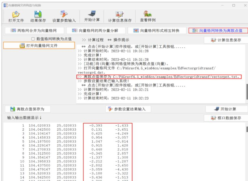
[输出]离散点值文件。无头文件，记录格式：点号，经纬度（度小数），转换后的（向量）格值。经纬度取单元格网中心点的经纬度。
